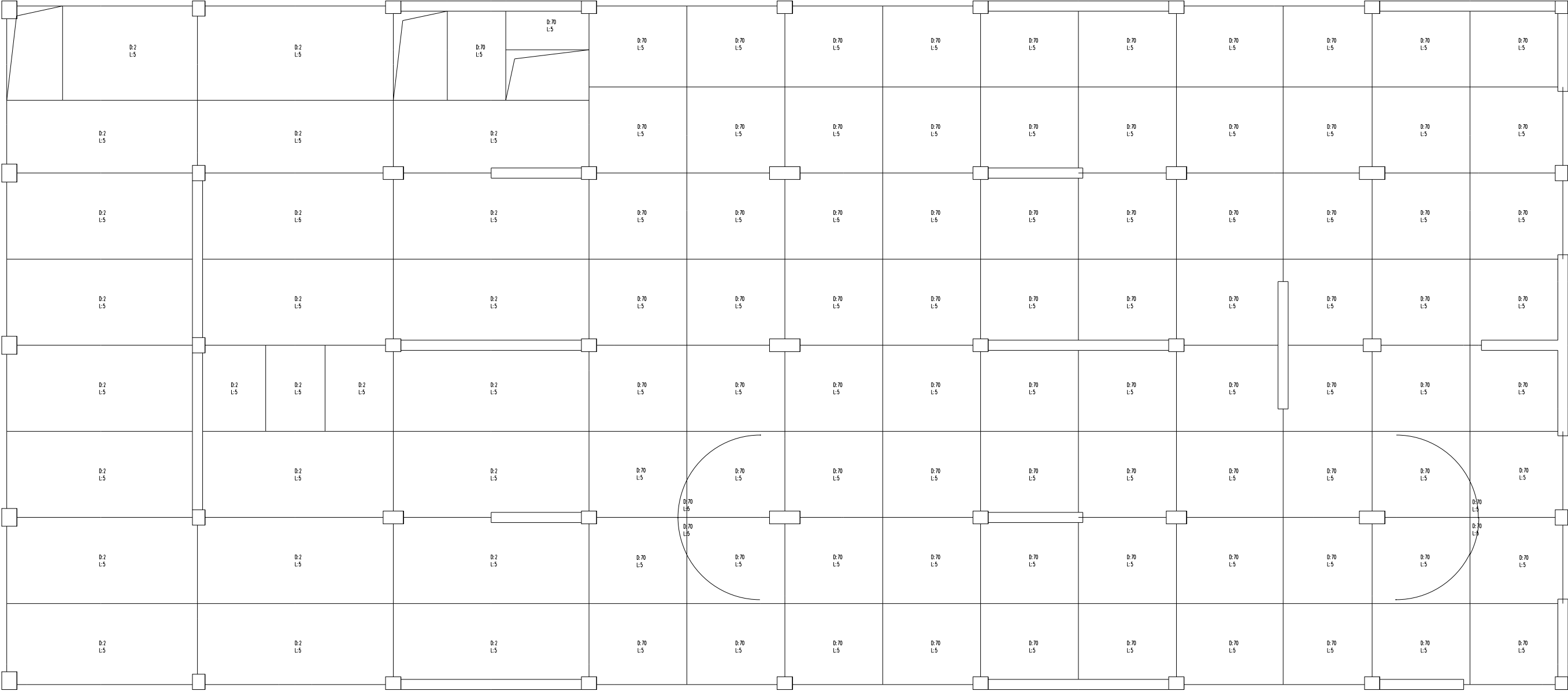
第 2 层(第 2 层)楼面荷载简图 [ 荷载值: L:5 荷载: 0.70kN/m2 ]
